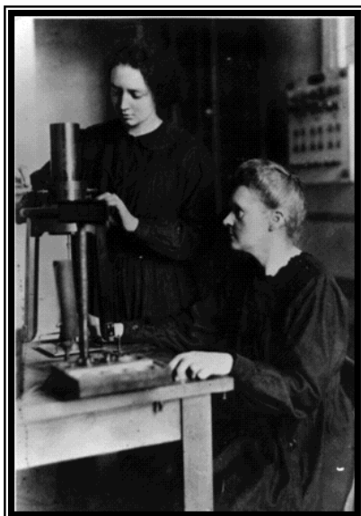
Fig. 92 - Dès 1919, Irène assiste sa mère à l'Institut du Radium. Sur cette photo prise en 1921, les deux femmes utilisent un quartz piézoélectrique étiré par un poids.
