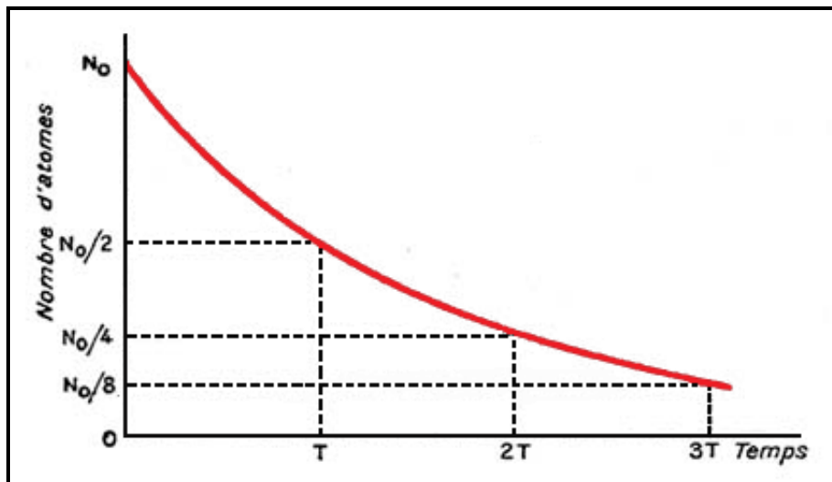
Fig. 6 – Décroissance d'un corps radioactif. S'il y a à l'origine, N atomes, il n'en n'existe plus que la \frac{1}{2} , au bout d'un temps T , \frac{1}{4} au bout de 2T , etc.
